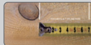
Fig 6: Esempio di troncatura a 7 cm dal nodo, ciò consente notevoli miglioramenti del prodotto finito.
